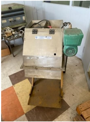
Séparateur magnétique basse intensité
